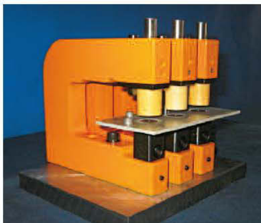
Locheinheiten durch eine Schablone positioniert
