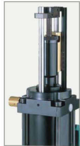
Feineinstellung des pneumatischen Krafthubs
