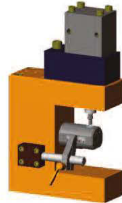
161-RLA-50 Hydraulisch doppelwirkend Ausladung A = 50 mm Zylinderkraft 68 kN bei 350 bar Öleingangsdruck
