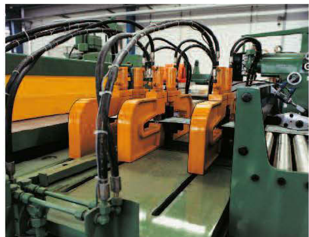
Hydraulisch doppelwirkende Locheinheiten, auf Verschiebeelementen gelagert, zum Bearbeiten von unterschiedlich breiten Stahlbändern.
