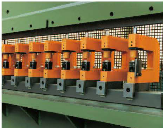
Werkzeugeinheiten zum Lochen in einer Abkantpresse
