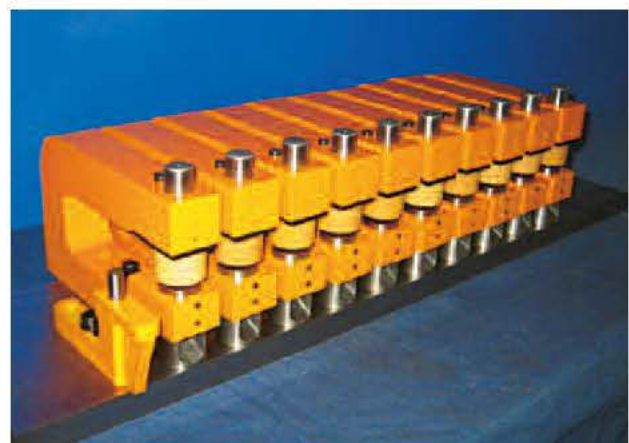
Locheinheiten durch eine Positionsplatte eingerichtet
