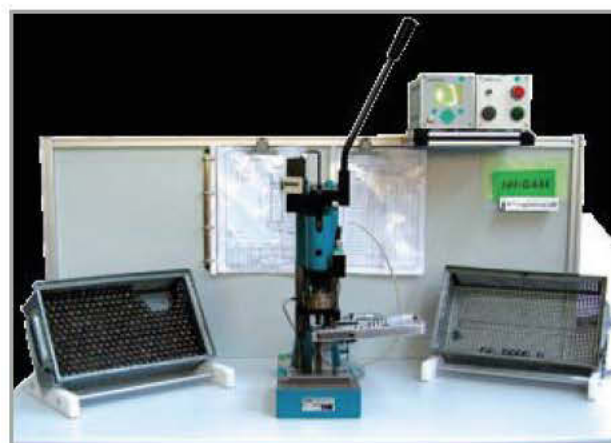
Handarbeitsplatz mit TPC-MIDI angebaut an Kniehebelpresse EP 500-40
