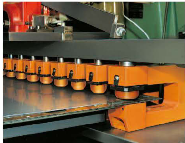
Werkzeugeinheiten zum Lochen in einer Exzenterpresse
