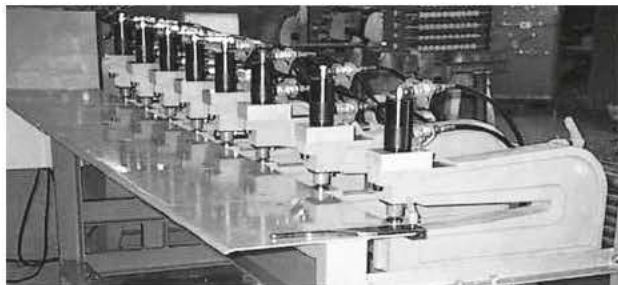
Hydraulik-Kurzhubzylinder zum Betreiben von Locheinheiten als Reihenlochanlage.
